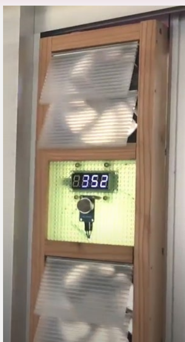
中学校：密を感じ取って換気を行う装置
