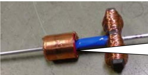
モータの回転子です。軸は中学生でも切断できるアルミの棒。コアには『手づくりソフトフェライト磁石』を用い約200ガウスの磁力が発生します。整流子は心を真ん中に取りするためビニールテープを巻いた上に銅箔テープを貼って作りました。
