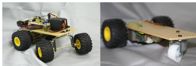
図1 1 モータ駆動型（左）と 2 モータ駆動型（右）
