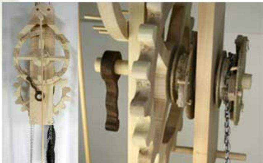
(写真右)「時光」の動力部。ラチェット機構になっている部品に丸棒が埋めてあり、鎖が自然に噛み合うよう工夫した。鎖を巻き取る時、他方に負担をかけない仕組みになっている。
