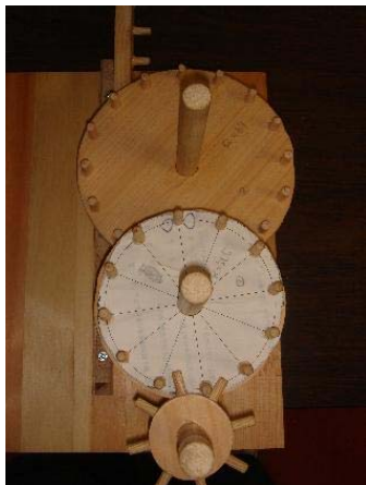
図2 内部の歯車機構
