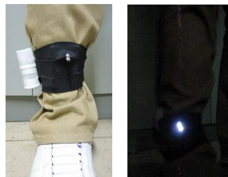
(a)装着時の様子 (b)点灯時の様子 図5 製作した電池なしライト
