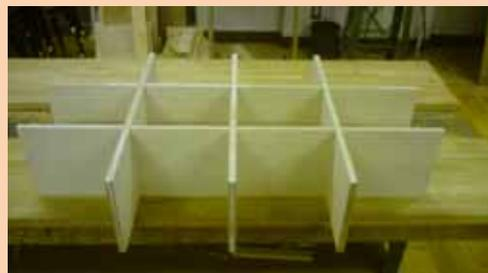
上図は製作途中の棚です。五枚の板を相欠き接ぎで組み立てました。下左図が三枚, 下右図が二枚, 同じものを作り組み合わせました。
