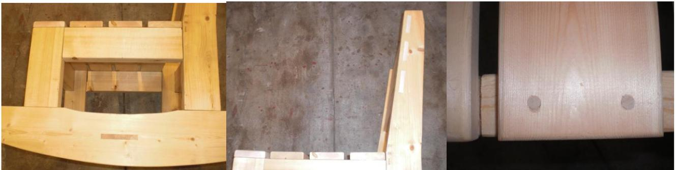
座板以外の接合方法は、釘を使わずほぞで接合した。場所によってほぞの種類を変えている。座板の部分はだぼで接合した。また、表面は手触りが良いように、かんなどやすりで滑らかに仕上げた。
