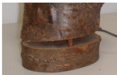
図6 底板の取り付け
