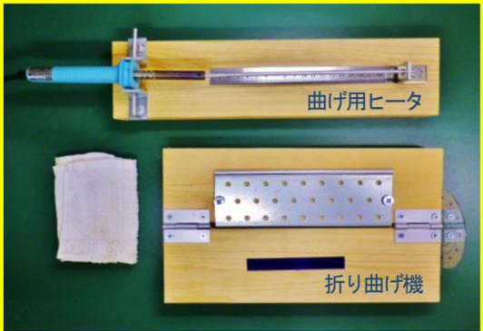
図1 製作した「簡易プラスチック折り曲げ機」
