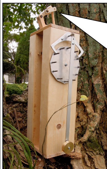
図3 オートマタを組み込んだ機械式振り時計
