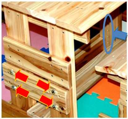
図4 ボルトで調整を可能に (内側の側板に調整用の穴)
