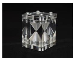
爪先交換式生爪を使用して製作したオブジェ
