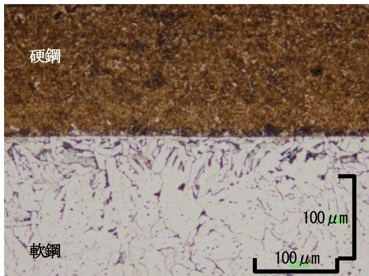
図3 接合鏡面の顕微鏡写真
