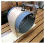
ねじれ防止のため、治具 と材料の中心線を合わせ て固定し乾燥させる。
