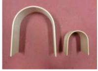
十分に乾燥したら治具から外して もドライングセット効果で形状は 固定される。
