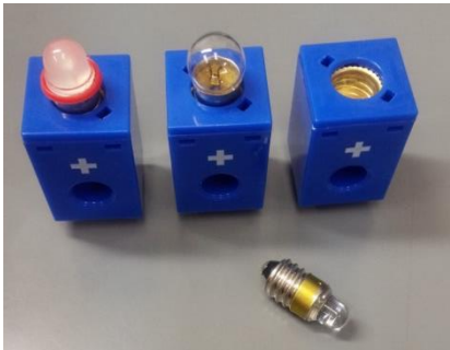
図2 LED や白熱電球の接続ソケット
