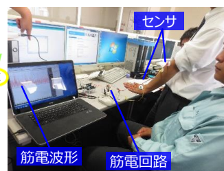
図3 筋電回路作製班が腕の筋電波形をデジタルオシロスコープで確認している様子
