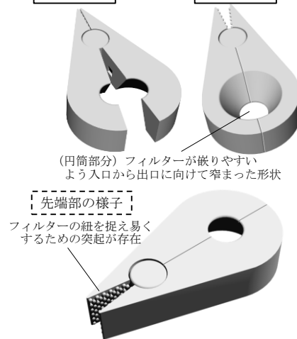
図2. CADにより作製した圧搾器の設計図
