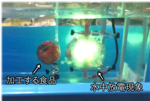
高電圧を水中放電した瞬間
