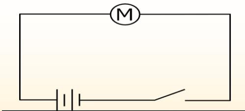
モータ、ギアボックス、電池ボックスからなるシンプルなもの。スイッチ部分は金属製の万能フレームを折り曲げて図1のように配置し、その下部にアルミホイルでくるんだホッチキスの針（磁性材）を置いた。これに上部から磁石を近づけるとアルミホイルでくるんだホッチキスの針が持ち上がり、万能フレームと接触して導通するようにした。
