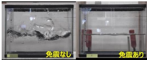
図 約震度6強相当の加速度を与えた時の水面の様子の比較
