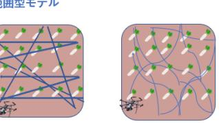
ロボット掃除機の動きを参考にした動作モデル
