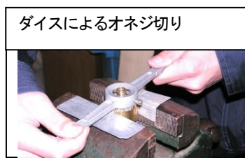
図4 ろうそく立て上部のダイスによるオネジきり
