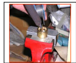
図5 ろうそく立て上部と黄銅釘とのはんだづけ
