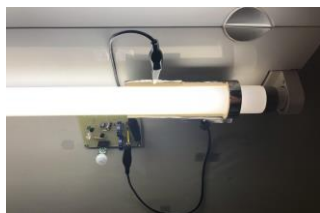
図3 天井設置の蛍光灯に実装した様子
