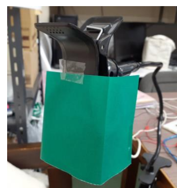
図3: 超音波センサの周りを紙で囲んだ状態
