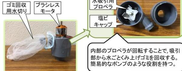
内部のプロペラが回転することで, 吸引部から水ごとくみ上げゴミを回収する。簡易的なポンプのような役割を持つ。
