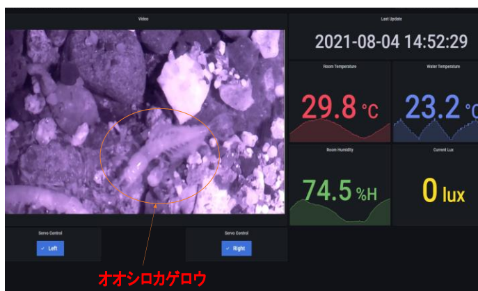
図5 水槽内の映像、水温、照度のリアルタイム監視
