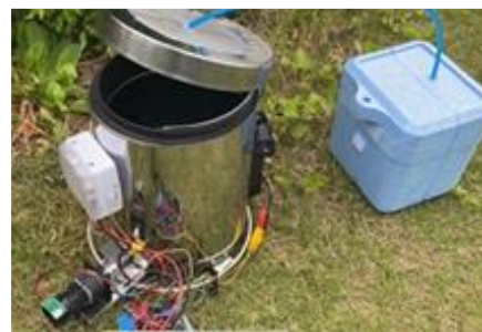
図 1 開発した蚊のサンプリングマシン
