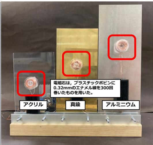
電磁石は, プラスチックボビンに0.32mmのエナメル線を300回巻いたものを用いた。
