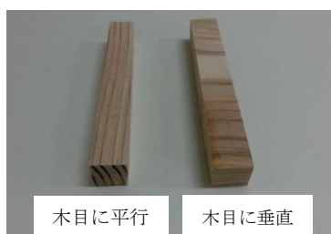
図 14 繊維方向による強度の違いを調べる木材片 (断面寸法：12mm×12mm，長さ：100mm)
