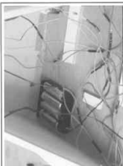
装置内の二次電池(ニッケル水素電池)
