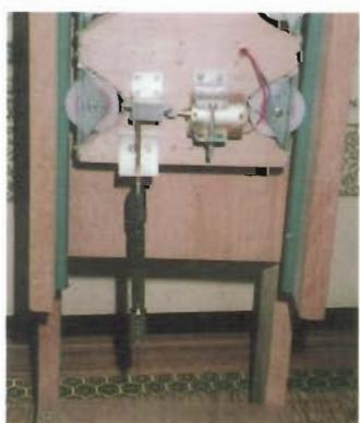
工夫点の3つ目はモーターの回転数をおとしてドリルの力を強めたことです。写真1は改良前のものでしたか、実際に使用してみると、電圧をモーターの限界まで上げているにもかかわらず、力が弱かったので、自転車の変速器の原理を利用して、回転数をおとしたしました。それによって、少しは、ドリルの力が強くなりました。しかし、写真3を見てみるとわかるように、いろいろはぐるまの位置をかえてみたりしたので、ドリルについている板には、なくともいい穴があいていて、少し汚くなってしまって残念です。
