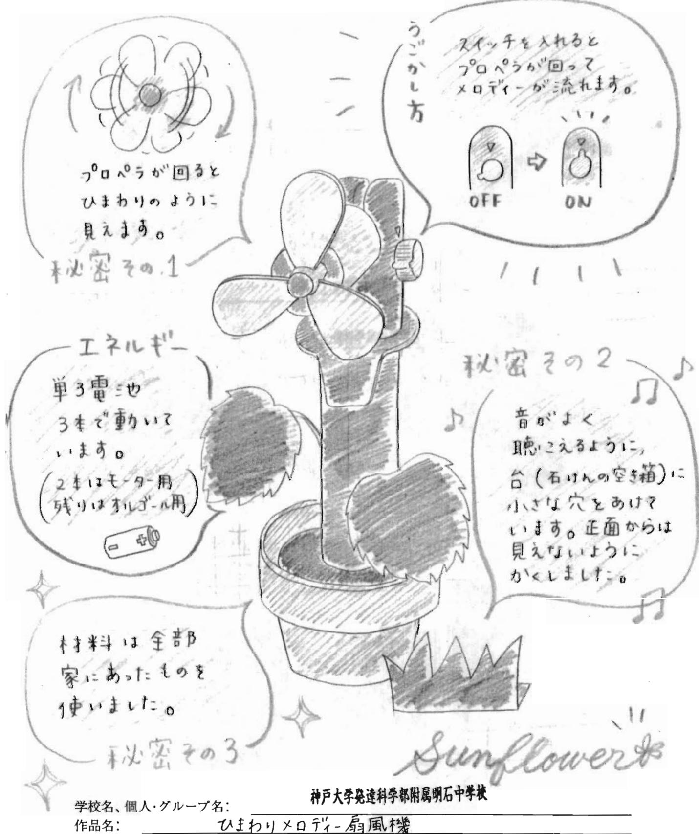
〔説明その1〕 「エネルギー変換」工夫作品コンテスト（製作作品写真）
