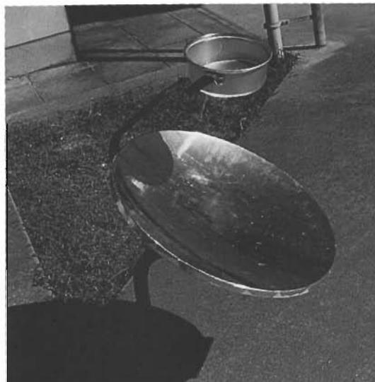
アンテナ上部の四角の部分に水を入れた容器を置いて、アンテナで反射した太陽光で湯を沸かすところ。
