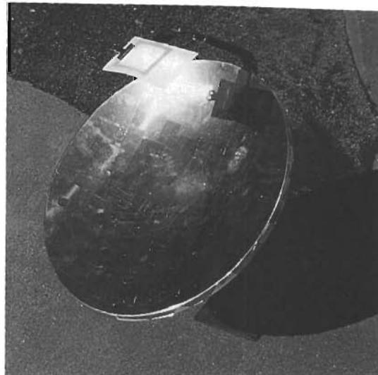
太陽光を効率よく集光するためアンテナ上部の四角の部分に白い紙を置いて、太陽光が集中するように調節しているところ。
