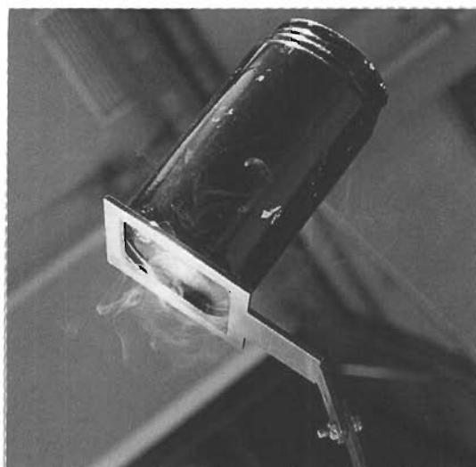
アンテナ上部の四角の部分に水を入れた黒く塗った缶を置いて、アンテナで反射した太陽光で、缶の底から、煙が出ているところ。
