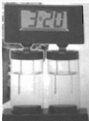
教科書に目を通していたら、「雨水で動く時計」の仕組みを見つけた。つくり方はいたって簡単!! 雨水に金属板2枚。一見、できそうだったのでチャレンジするが、全く動かない。試行錯誤するうち、持続性のある電池を得ることができた。
