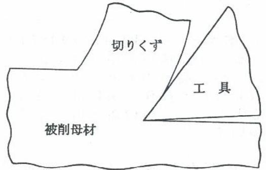
図8 被削母材・切りくず・工具の位置関係
