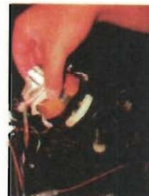
偏向コイルは 2 つのコイルが直角に磁場を作っています。コマを回すと磁界が変化して A コイルに電流が流れます。その電流をアンプで増幅し、もう一方の B コイルに流してやりませう。この B コイルの作る磁場によってコマが加速される仕組みです。
