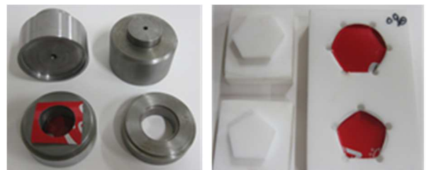
左から 打ち抜きの型、曲げの型
